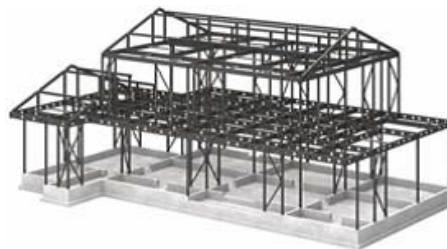
図1: 2階建住宅の立体骨組みの例 ([1] より引用)
